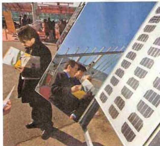
Durch die Spiegel wird das Licht fünffach gebündelt; Das Konzentratorsystem ZT-2000 C als Prototyp auf der Genera.
